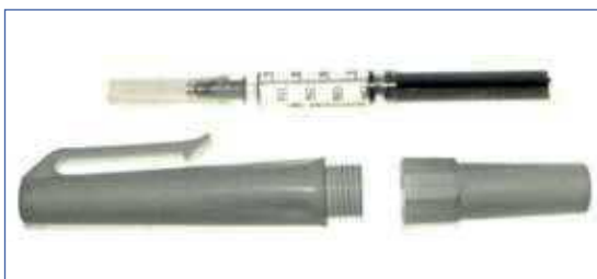
Obrázek č. 3: Ručně upravená plastová stříkačka Chirana 2 ml, Stará Turá, s nasazenou jehlou a sériově vyráběné plastové pouzdro. Rok 1985. Zdroj: archiv autora
