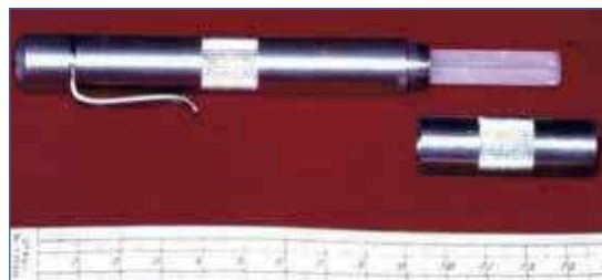
Obrázek č. 2a: Jedno z prvních kovových tužkových pouzder s upravenou plastovou stříkačkou Chirana 2 ml. Pouzdro vysoustruhoval člověk, který chtěl lidem s diabetem zlepšit komfort léčby inzulínem. Rok 1981. Zdroj: archiv autora
